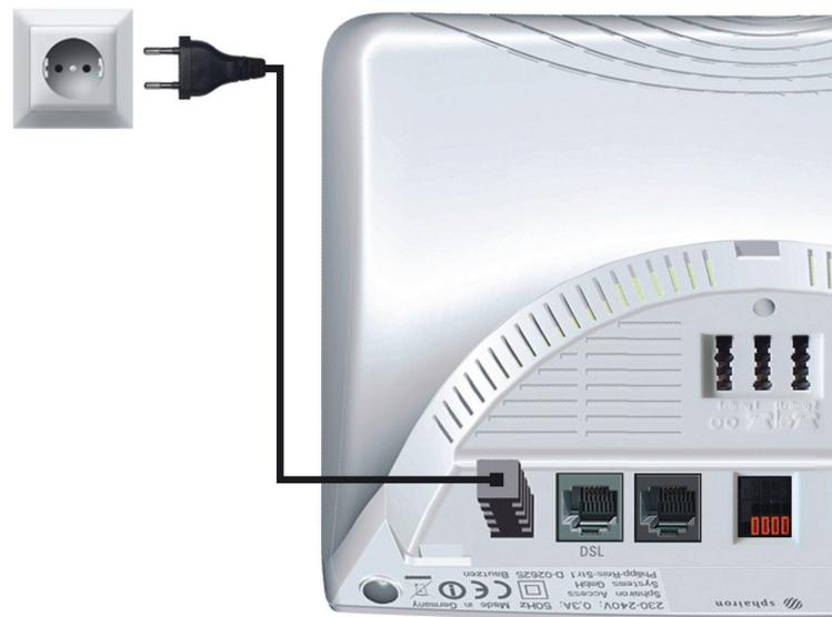
Verbinden Sie das Alice IAD WLAN 3232 mit dem Stromnetz.
