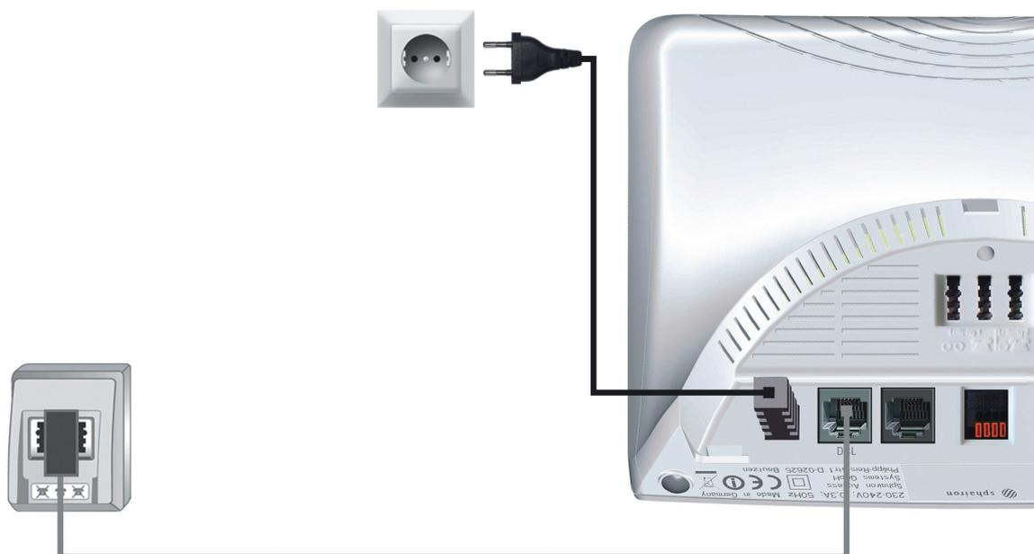
Verbinden Sie das Alice IAD WLAN 3232 mit der Telefondose.
