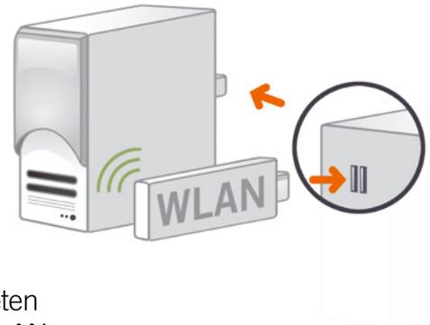
Kontrollieren Sie die **WLAN** LED auf der Vorderseite Ihres Alice Modem WLAN 1421. Diese muss dauerhaft grün leuchten. Wenn nicht, drücken Sie den mit **WLAN** beschrifteten Taster an der Geräterückseite einmal kurz. Damit wird die WLAN Funktion aktiviert und die **WLAN** LED leuchtet dauerhaft grün.
