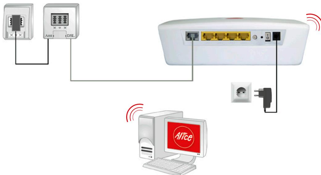
Verbinden Sie das Alice Modem WLAN 1421 mit dem Telefon-Hausanschluss.
