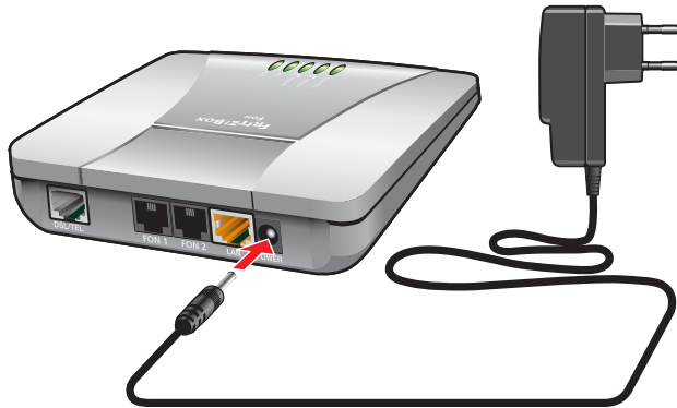
Anschluss an die Stromversorgung
