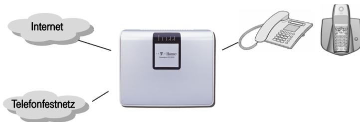
An den Anschluss für das Telefon
