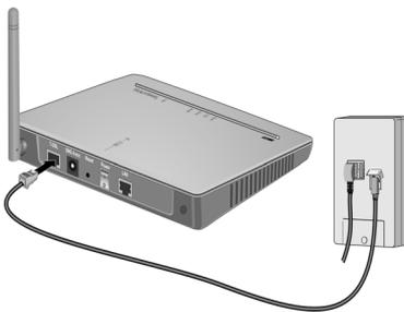
➔ Für den Anschluss an den Splitter stecken Sie das mitgelieferte Ethernetkabel (CAT-5) in die mit T-DSL gekennzeichnete Buchse an der Rückseite des Geräts.
