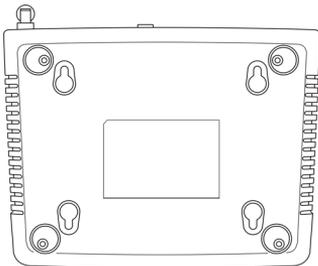
Sie können Ihren Speedport W 500 auch an der Wand befestigen. Dafür sind auf der Unterseite Bohrungen angebracht.
