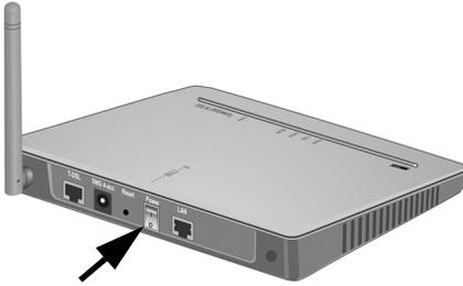
➔ Schalten Sie den Speedport W 500 über den mit „Power“ beschrifteten Schalter auf der Rückseite des Gerätes ein.
