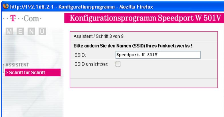
Schritt 3: Ändern des Namens des WLAN-Funknetzwerks.
