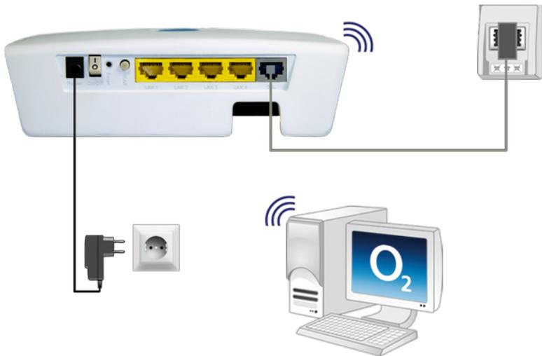
Verbinden Sie die O<sub>2</sub> Box 4421 mit der Telefondose.
