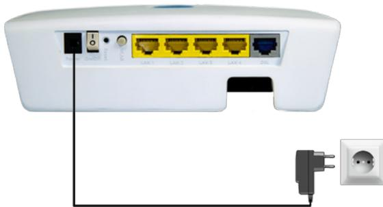
Verbinden Sie die O<sub>2</sub> Box 4421 mit dem Stromnetz.
