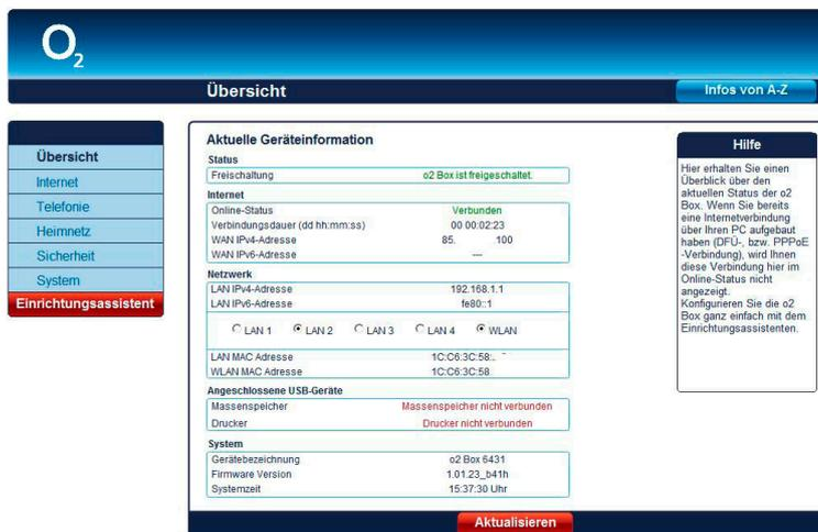
Wenn Sie bereits eine Internetverbindung über Ihren Computer aufgebaut haben (DFÜ, bzw. PPPoE-Verbindung), wird Ihnen diese Verbindung hier im Online-Status nicht angezeigt.
