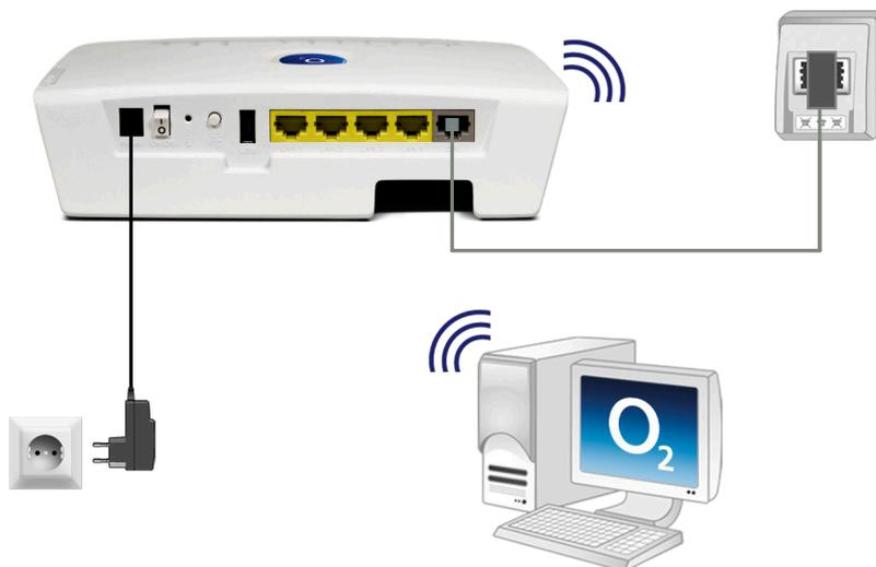
Verbinden Sie die O<sub>2</sub>Box 6431 mit der Telefondose.
